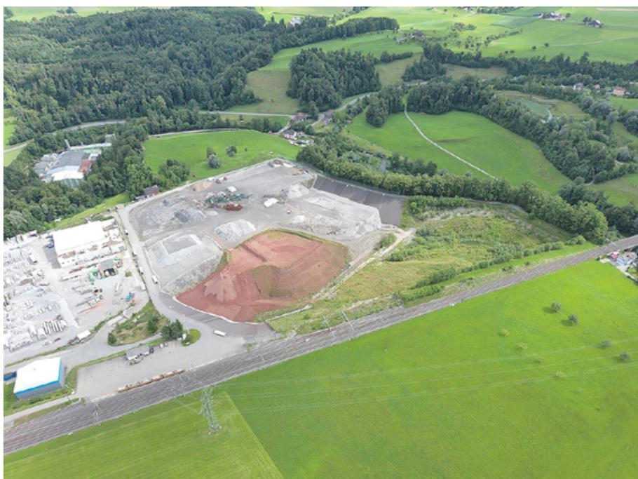
die Basisabdichtung eingebaut und nach dem Zeitplan sollen im Jahr 2025 die Böschungsabdichtungen gebaut werden. Nach dem Abschluss dieser Bauarbeiten wird ein weiteres Nutzungsvolumen von rund 350'000 Kubikmeter zur Verfügung stehen, welches für die nächsten 10 bis 15 Jahre ausreichen wird. Die Bevölkerung wird während den Bauarbeiten kaum zusätzliche Emissionen zu spüren bekommen.
