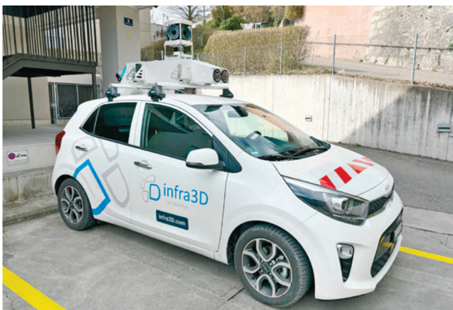
Mit speziellen Messfahrzeugen wird bis voraussichtlich Ende Juni 2025 das Strassennetz digital erfasst. Foto: GEOINFO
