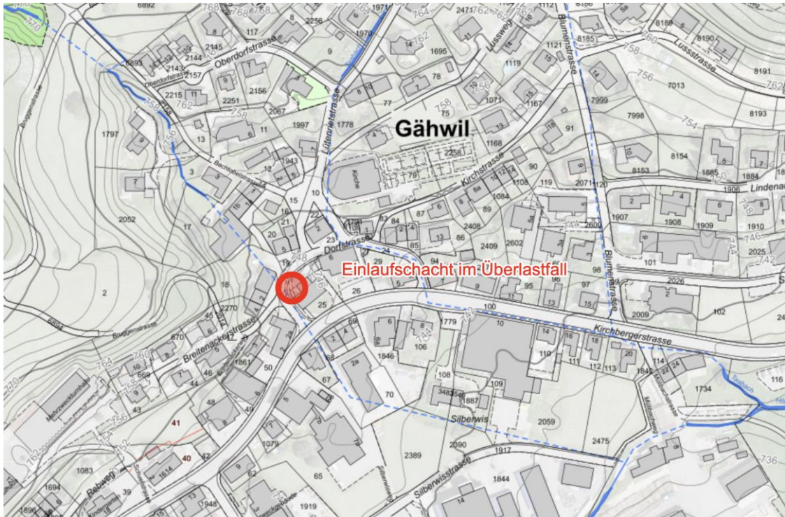
Abbildung 9: Standort des ursprünglich angedachten offenen Kanalabschnitt zur Aufnahme von Überlastwasser.
